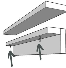
FAÇA A MONTAGEM DO SUPORTE DA TRAVESSA LATERAL COM OS PARAFUSOS 4X25 E DEPOIS FAÇA A FIXAÇÃO NA LATERAL DO BANCO A
