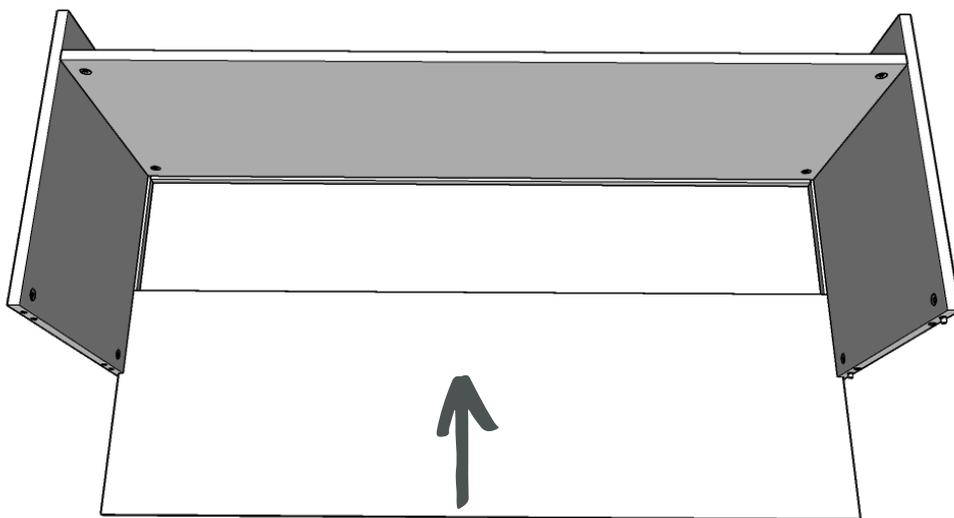
ESTE SISTEMA DE ENCAIXE DEIXA O MÓVEL MAIS FIRME E AO COLOCAR O MÓVEL NA POSIÇÃO O FUNDO NÃO TERÁ CONTATO DIRETO COM O PISO.
