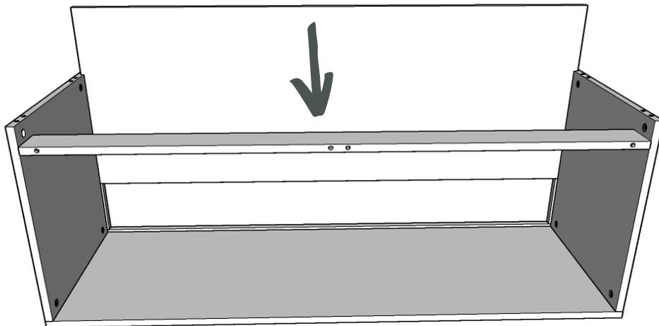
ESTE SISTEMA DE ENCAIXE DEIXA O MÓVEL MAIS FIRME E AO COLOCAR O MÓVEL NA POSIÇÃO O FUNDO NÃO TERÁ CONTATO DIRETO COM O PISO.
